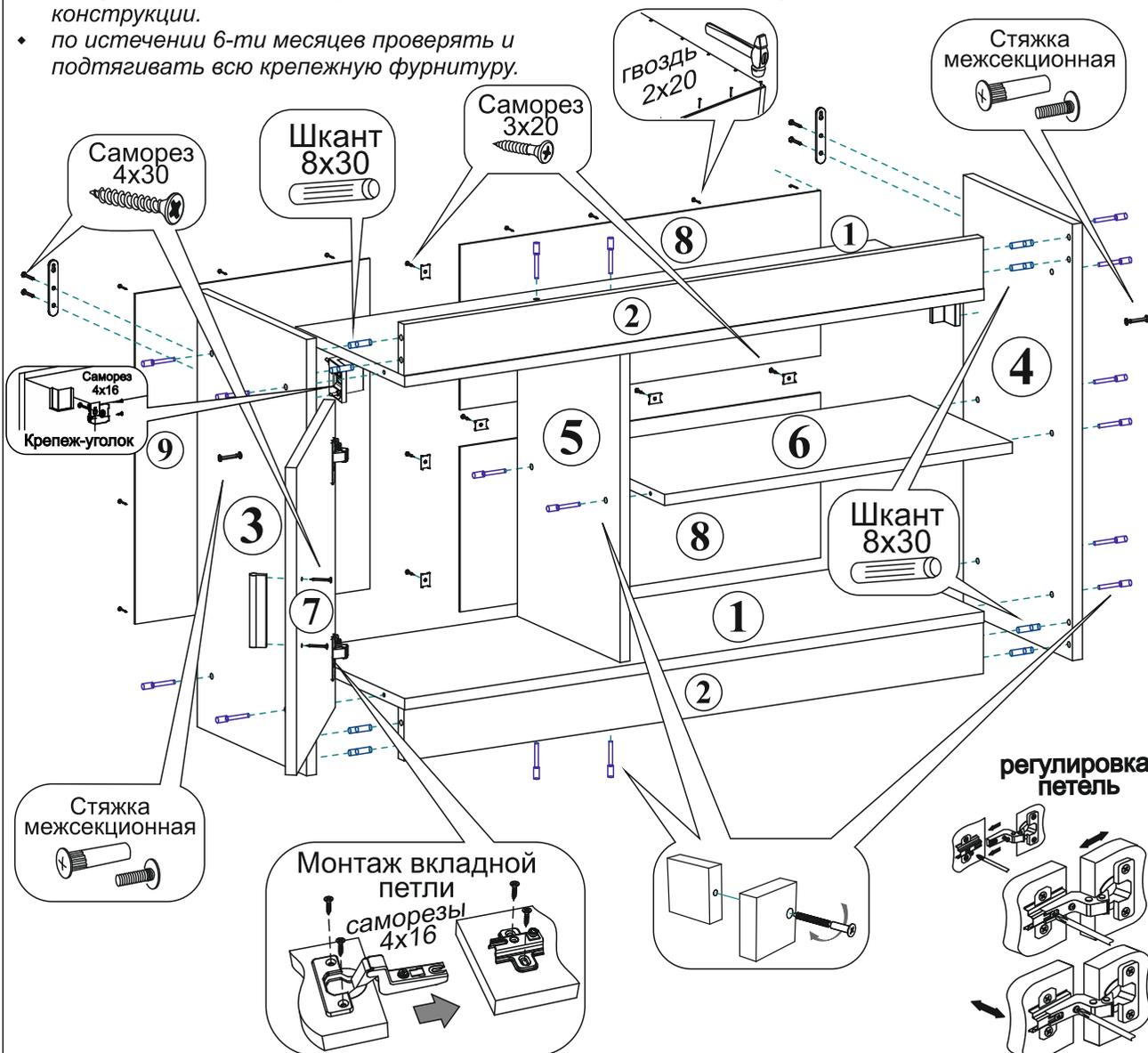
Саморезами 4x16 крепятся петли, 3x20-скрепа для ДВП. ЛДВП крепится гвоздями 2x20 и скрепой для ДВП на стыках.
