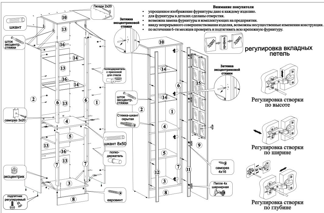
Для крепления ЛДВП применяются гвозди 2x20 и скрепа с саморезом 3x20.Саморезами 4x16 крепятся петли, стекло закрепляется при помощи кляймера ступенчатого и самореза 4x20.Если несколько модулей устанавливаются рядом, то их необходимо стянуть между собой межсекционными стяжками 25 мм, просверлив самостоятельно отверстия диаметром 5 мм в произвольных местах.
