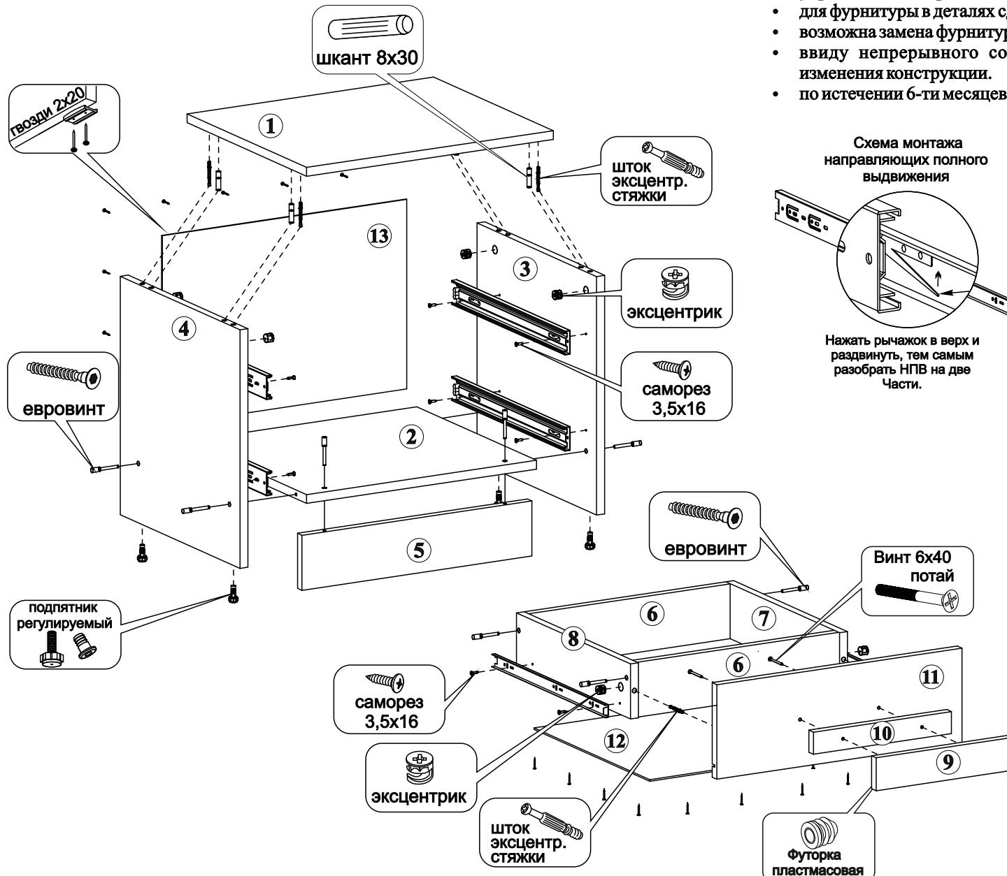
Для крепления ЛДВП используются гвозди 2x20. Саморезы 3,5x16 применяются для крепления направляющих.
