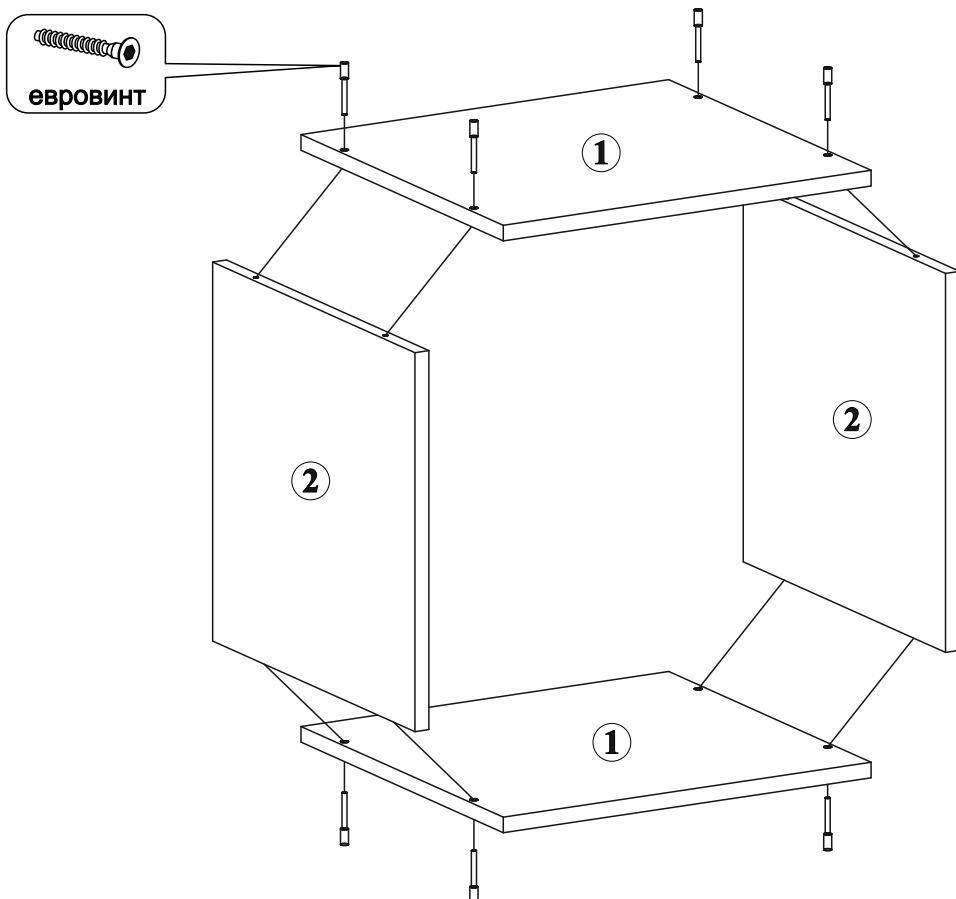
\*Рекомендуем при установке нескольких модулей стягнуть их между собой межсекционными стяжками просверлив предварительно отверстия диаметром 5 мм в произвольных местах.
