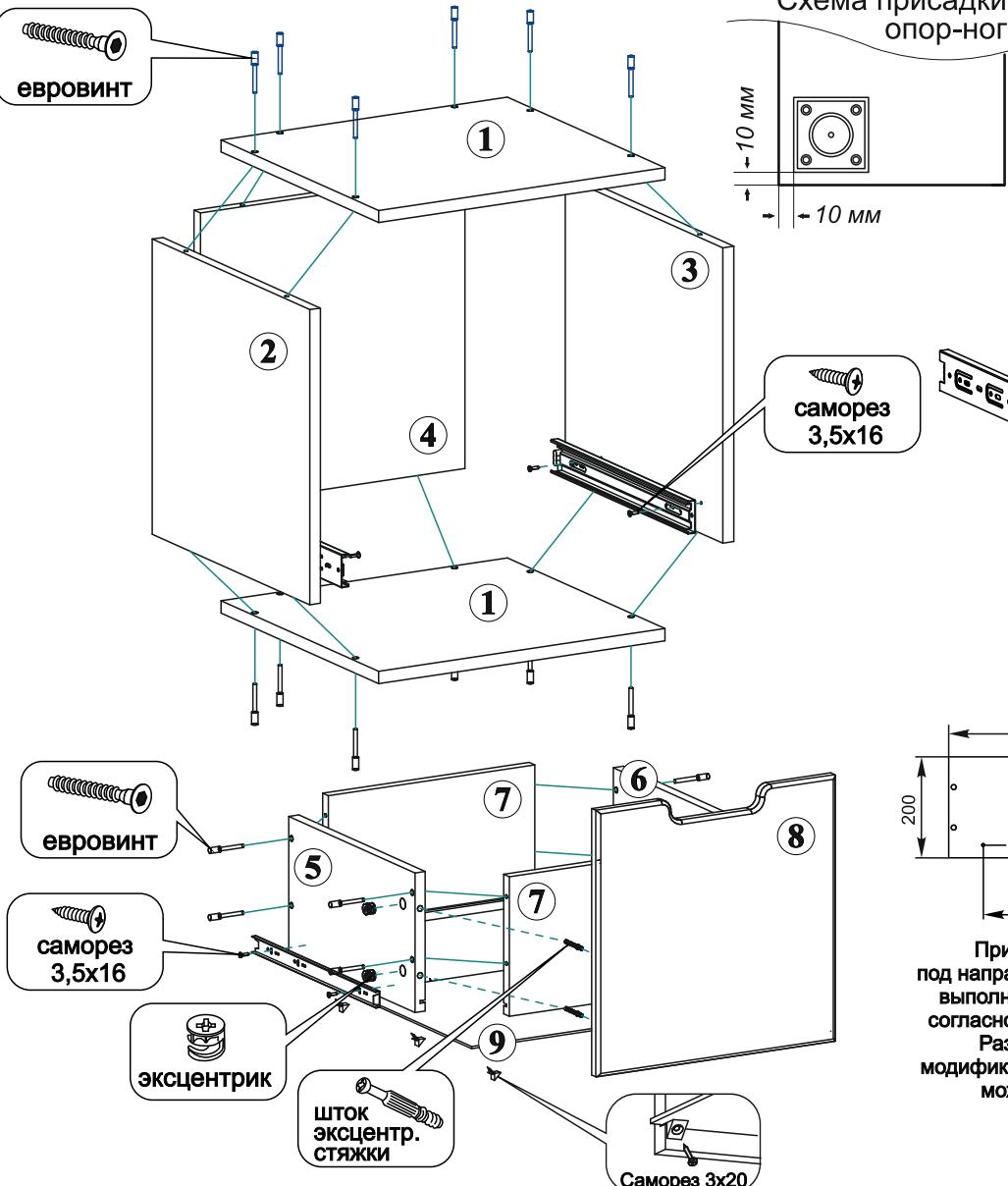
\*Рекомендуем при установке нескольких модулей стягнуть их между собой межсекционными стяжками просверлив предварительно отверстия диаметром 5 мм в произвольных местах.
