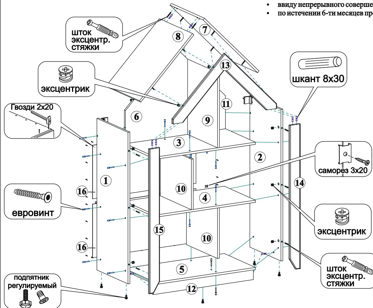
\*Для крепления ЛДВП используются гвозди 2x20 и скрепа с саморезом 3x20.
