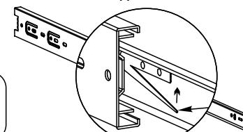
Нажать рычажок вверх и раздвинуть, тем самым разобрать НПВ на две части.
