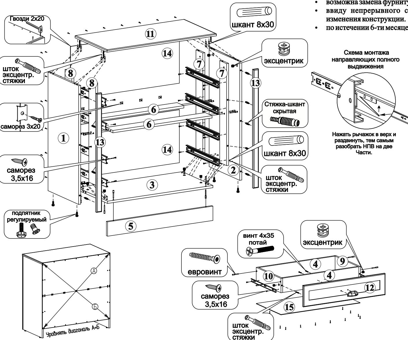
Для крепления ЛДВП используются гвозди 2x20 и скрепы с саморезами 3x20. Направляющие крепятся саморезами 3,5x16.
