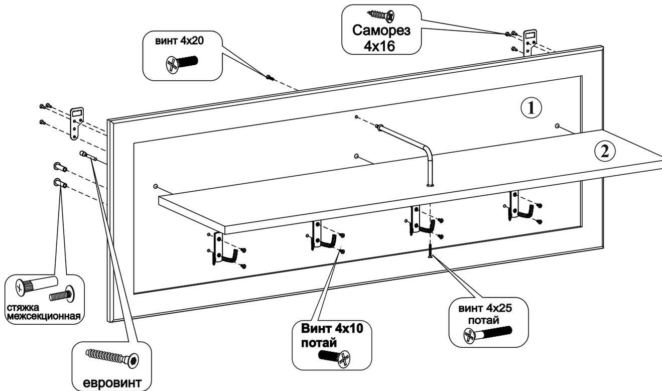
Для крепления полки к щиту применяется еврвинт. Саморезами 4x16 крепятся навесы.
